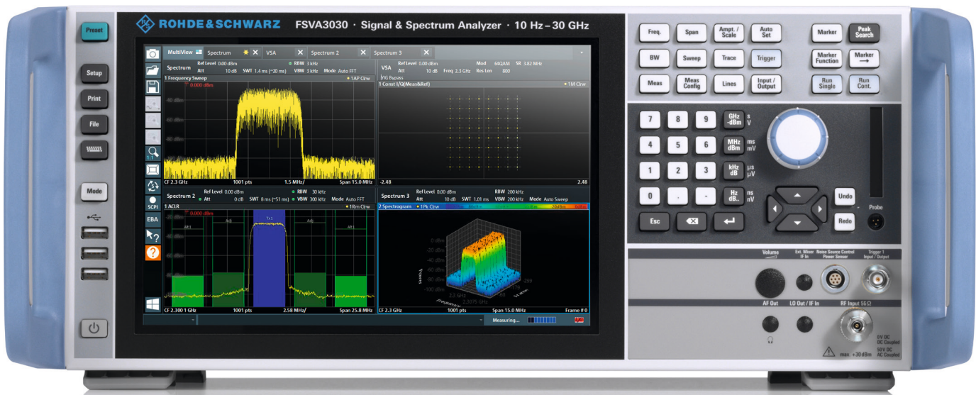
Вид передней панели прибора R&S®FSVA3000
